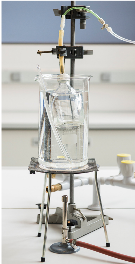
Figuur 42: de proefopstelling voor de gaswet van Regnault
