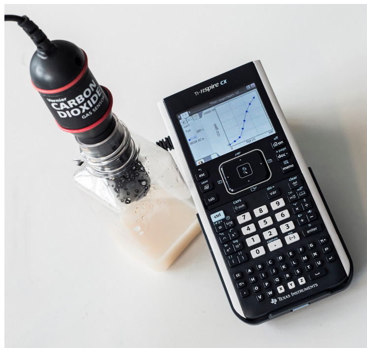
Figuur 27: proefopstelling van de CO 2 -sensor met de gistoplossing
