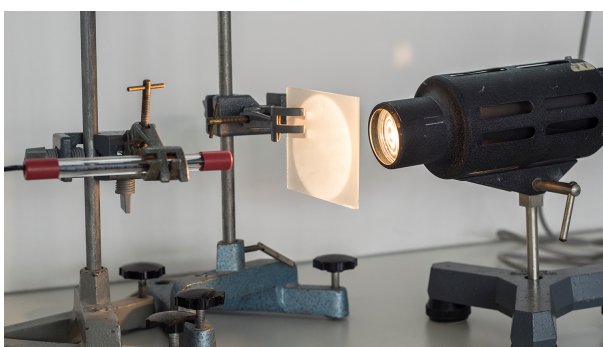
Figuur 29: plaatsing van de lamp, materiaal en lichtsensor
