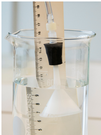
Figuur 39: proefopstelling bij meting hydrostatische druk
