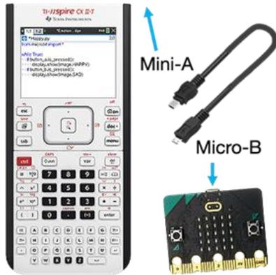
Abbildung 13: Mini-zu-Micro-USB-Kabel
