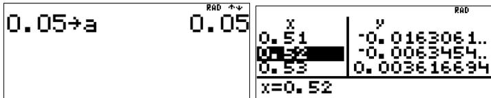
Dieses Beispiel entspricht dem eingangs abgebildeten Foto, bei dem eine Kugel mit dem Radius 0,05 m verwendet wurde. Das Maßband wurde nach Verlängerung um ca. 0,52 m durch Straffziehen von der Kugel entfernt.
